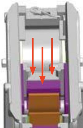
Правильно установите новую защитную вставку в нужном положении и придвиньте ее к пластмассовой направляющей. Удалите избыток kleя. Вставка должна быть расположена в одну линию с пластмассовой поверхностью, не выступая по длине.
