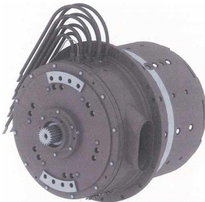
Рисунок 1 - Модель электродвигателя ЭДП-800 (вид со стороны коллектора)
