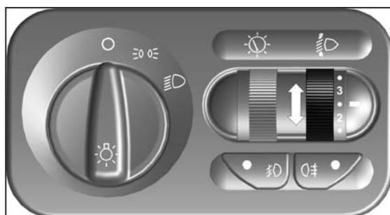
Позволяет при включенном ближнем свете фар корректировать угол наклона пучка света в зависимости от загрузки автомобиля:
