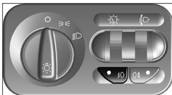
Включение передних противотуманных фар происходит при нажатии на клавишу выключателя при включенных габаритных огнях. При этом в клавише
