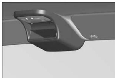
В потолочную консоль имеется возможность установить радиооборудование 1 DIN или тахограф.
