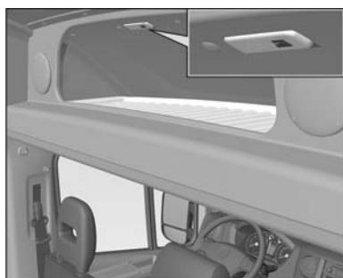
Для освещения внутреннего пространства над полкой для багажа в автомобилях с двухрядной кабиной предусмотрен плафон, включение/выключение которого осуществляется кнопкой. Освещение пространства над полкой в автомобилях с однорядной кабиной осуществляется плафоном, расположенным около боковой сдвижной двери.
