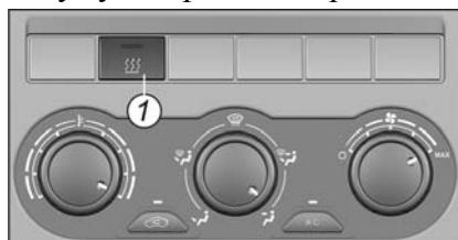
Догреватель включается кнопкой 1 при работающем двигателе и включенном отопителе. Далее догреватель работает в автоматическом режиме, повышая температуру теплоносителя, поступающего в систему отопления до 80-85°C, тем самым повышая эффективность ее работы в зимнее время.
