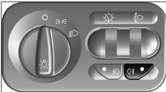
Включение задних противотуманных фонарей происходит при нажатии на клавишу выключателя, если включены ближний, дальний свет фар или передние
