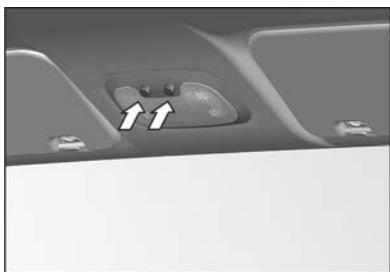
Плафон внутреннего освещения кабины расположен на обивке крыши в передней части. Плафон имеет две кнопки и общую секцию освещения кабины.
