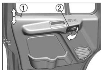
Для открывания заблокированной двери изнутри, потяните два раза ручку 2 на себя: первый раз – для разблокирования замка (кнопка 1 поднимется), второй – для открывания двери.
