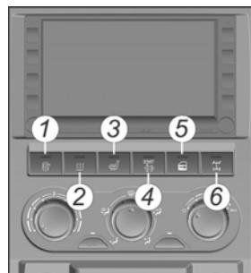
Выключатели имеют контрольные сигнализаторы включенного состояния.
