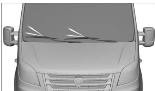
При недостаточном напоре струи воды (стеклоомывающей жидкости) в первую очередь проверьте наличие омывающей жидкости в бачке стеклоомывателя. Засорение отверстий жиклеров стеклоомывателя также может являться причиной недостаточного напора струи воды, при необходимости прочистите отверстия жиклеров.
