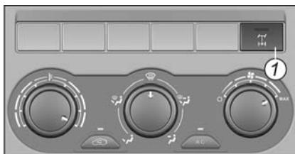
весь крутящий момент. Включение блокировки дифференциала осуществляется выключателем 1 на панели приборов.
