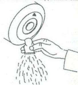
Рис. 6 Удаление пылевых отложений из клапана.
