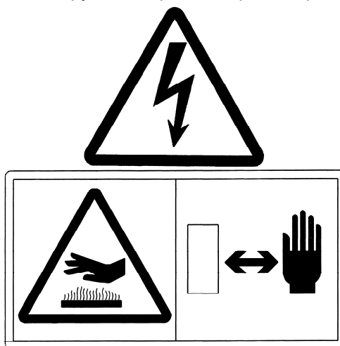
Рисунок 2.18 – Предупреждающие таблички. Опасность поражения высокой температурой. Перед выполнением любых работ обеспечить достаточное время для охлаждения.
