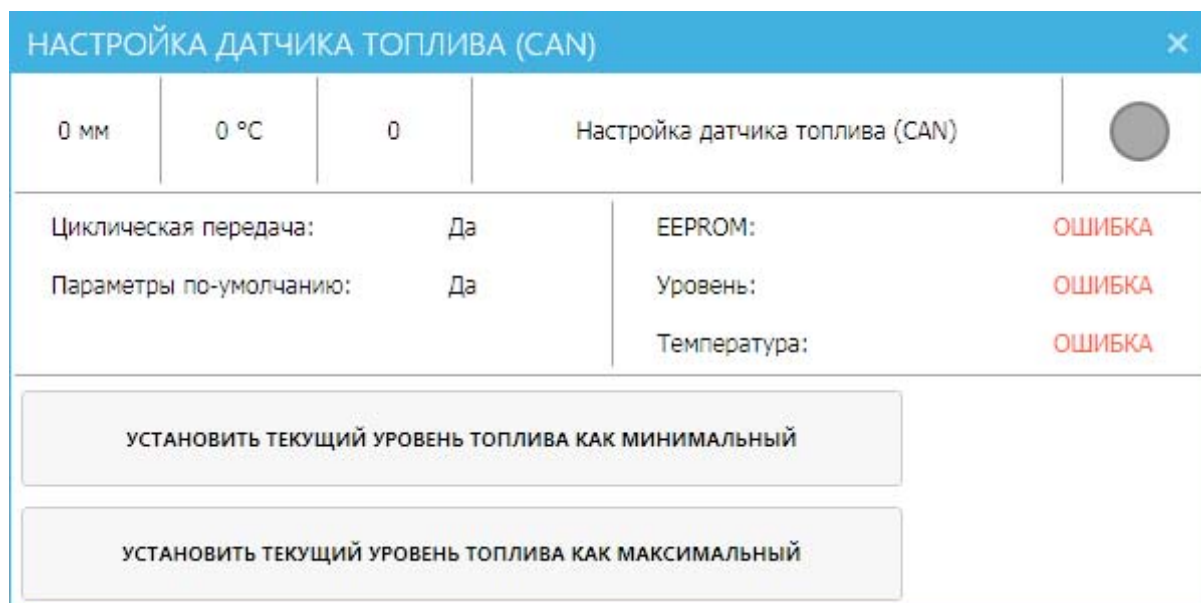
Рисунок Г3.15 – Окно “Настройка датчика топлива (CAN)”
