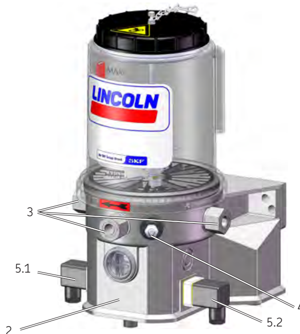
Рис. 2. Внешний вид, функциональное описание насосов без прижимного поршня
