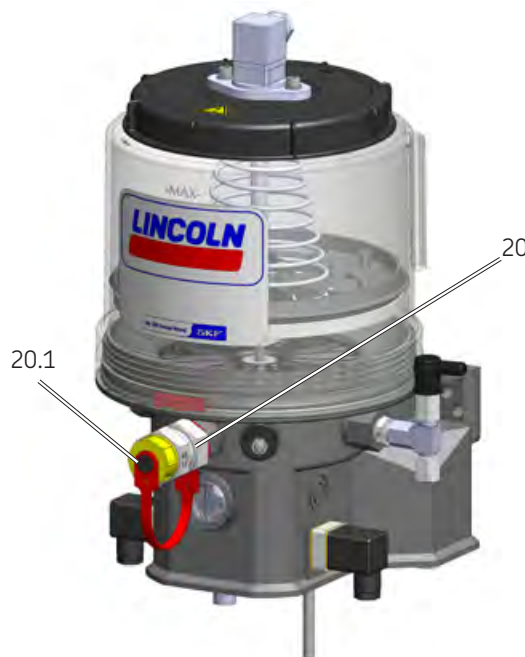
Рис. 15. Заполнение через опциональный заправочный штуцер
