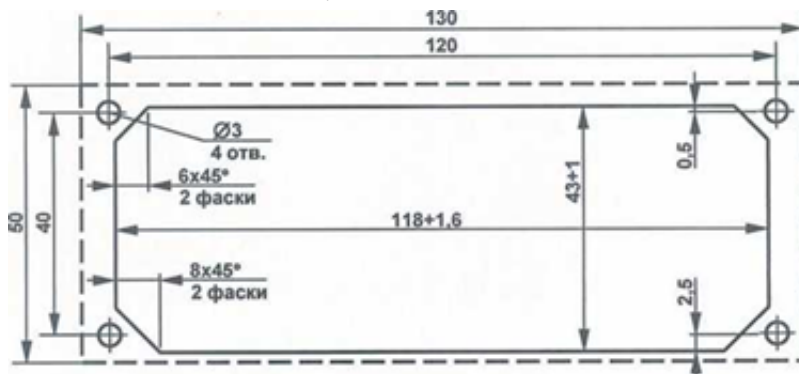
Рисунок 6.3 - Отверстия под установку блока сигнализатора
